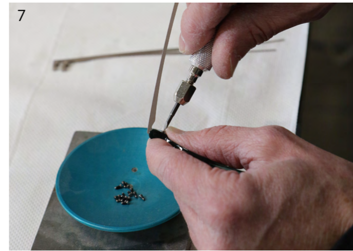
7. Assemblage de la branche et de la monture avec les charnières (Lucal)
